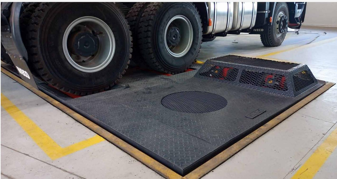
El sistema genera carga con frenos de corrientes parásitas refrigerados por aire evitando de esta manera el montaje de un circuito de agua. Sólo se requiere la preparación de la fosa para colocar el chasis del dinamómetro y el equipo queda listo para funcionar. El ingreso-egreso de vehículos se realiza con un elevador neumático o freno de bloqueo, cada parte de los BRF está pensada para asegurar una vida útil de muy larga duración y mínimos requisitos de mantenimiento.
