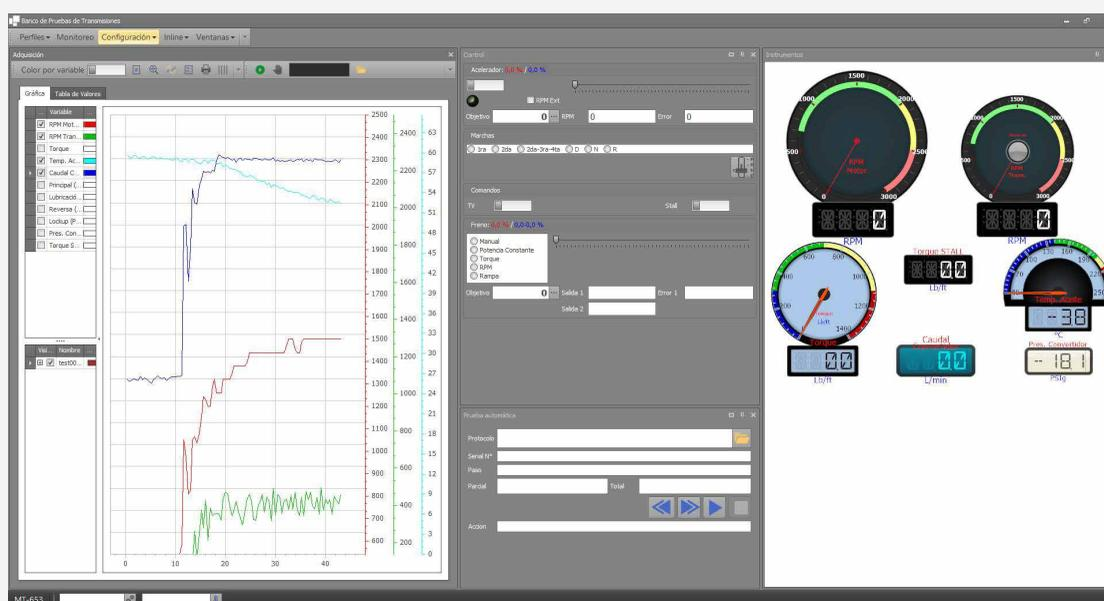
El Software *SMAC* permite al usuario tomar control sobre el dinamómetro de forma remota y realizar pruebas de forma completamente automática siguiendo protocolos preestablecidos. El sistema releva los sensores de entrada (*RPM, presión, temperatura,*
